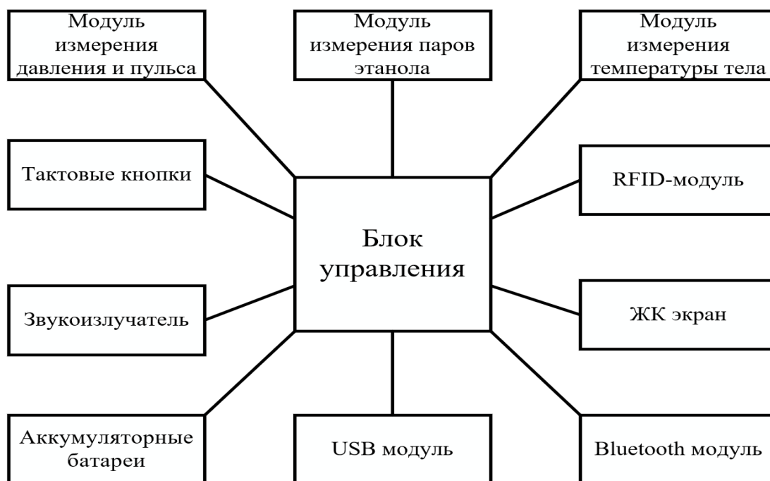
Рисунок 1 – Структурная схема Комплекса
